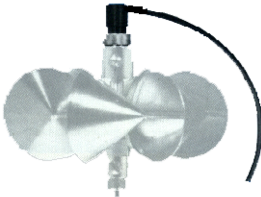
Figure II-4. Fibre optic retrofitted Price 622AA.
