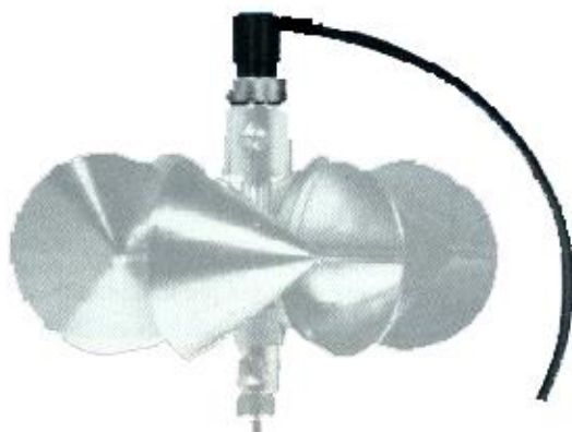
Figure II-4. Fibre optic retrofitted Price 622AA.
